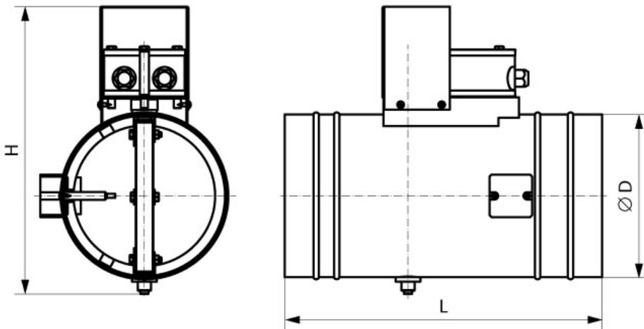
Минимальный диаметр клапана с электромеханическим приводом  $\varnothing$ 250 мм.
