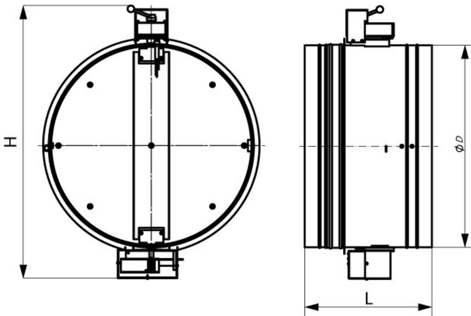
Минимальный диаметр клапана с электромагнитным приводом  $\varnothing 200$  мм
