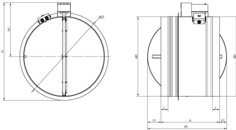
Минимальный диаметр клапана с электромеханическим приводом  $\varnothing 100$  мм.
