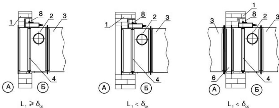
$L_1$  – длина корпуса клапана от фланца до края защитного кожуха или ограничительного уголка, мм (данная часть клапана устанавливается в строительной конструкции или в наружной огнезащите);
