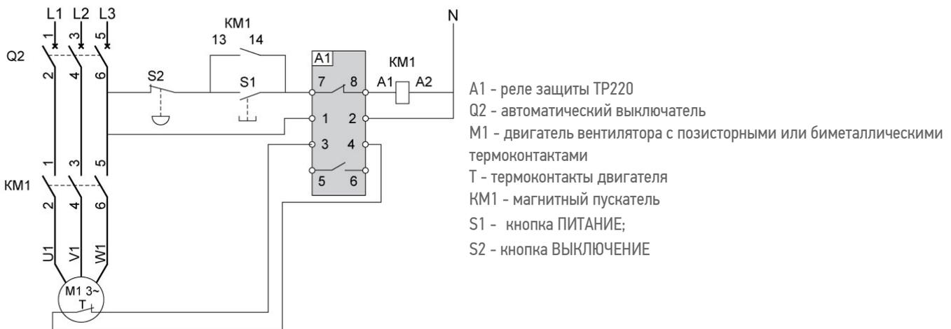
При нажатии кнопки S1 подается питание 220 В на катушку магнитного пускателя KM1.
